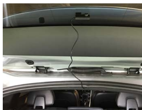
ARRIÈRE (coffre ouvert) : Objectif à droite, câble à gauche.
